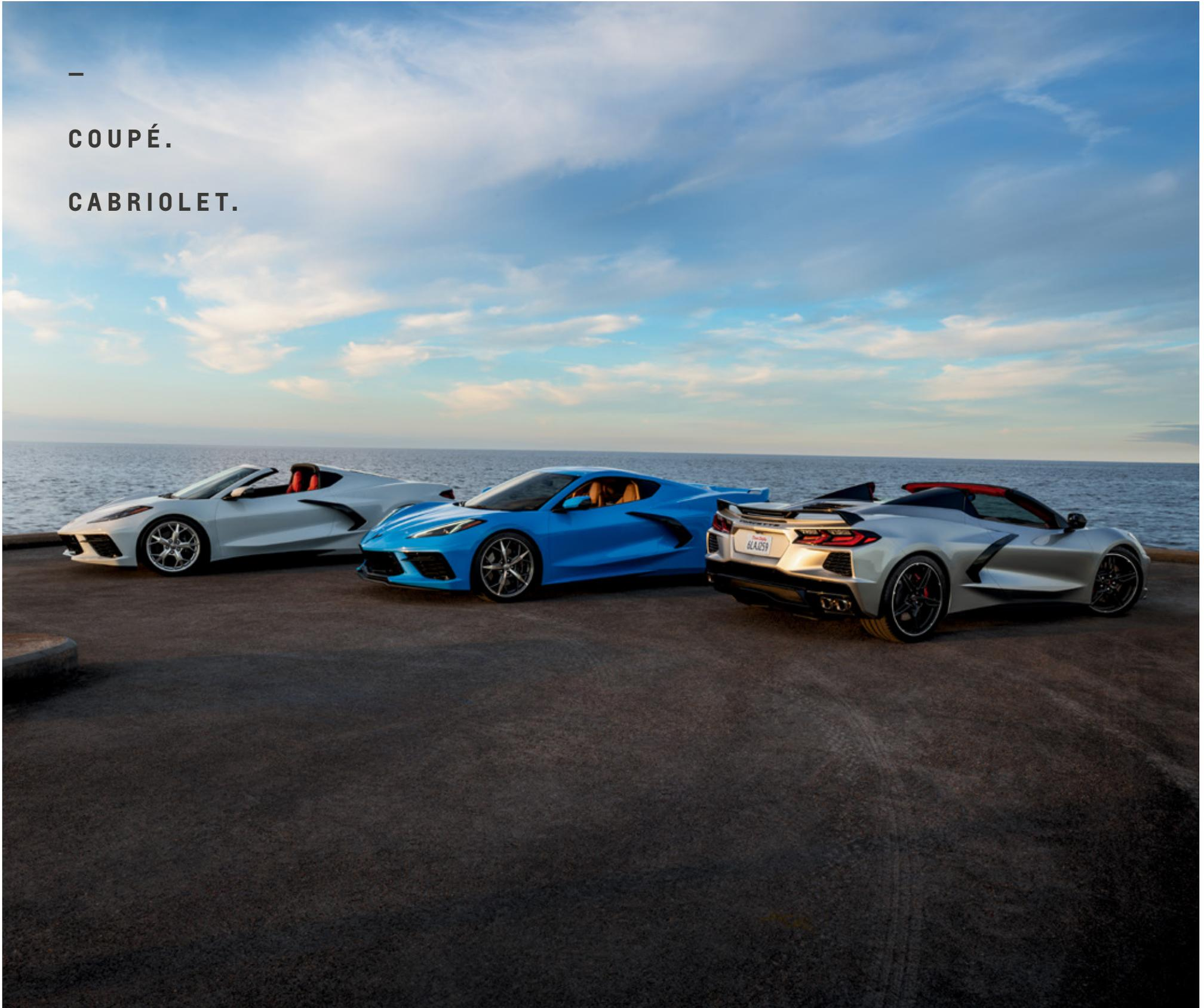
Le coupé Stingray est doté d'un toit amovible léger et facile à enlever qui se range aisément dans le coffre arrière. Il est disponible soit dans la teinte de la carrosserie, soit en version transparente ou en fibre de carbone. Le hayon du coupé est également doté d'une vitre laissant apparaître le moteur.
